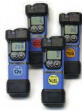
سنجنده های گاز های اکسیژن، H 2 S، منو اکسید کربن و گاز های قابل انفجار با منشاء کربنی (LEL)
