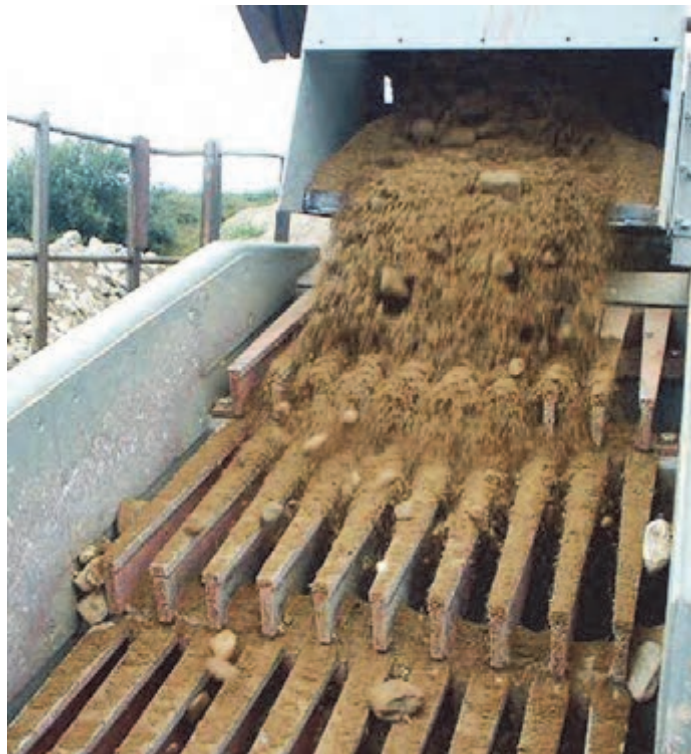
فیدر (تغذیه‌کننده) و سرند گریزلی سنگ‌شکن فکی
