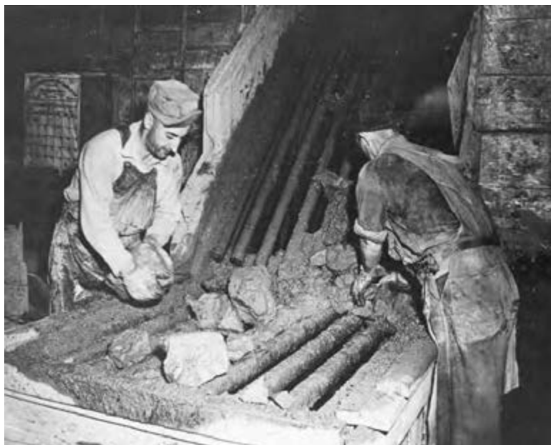
سنگ‌جوری دستی بر روی سرنده گریزلی قبل از ورود به مرحله خردایش
