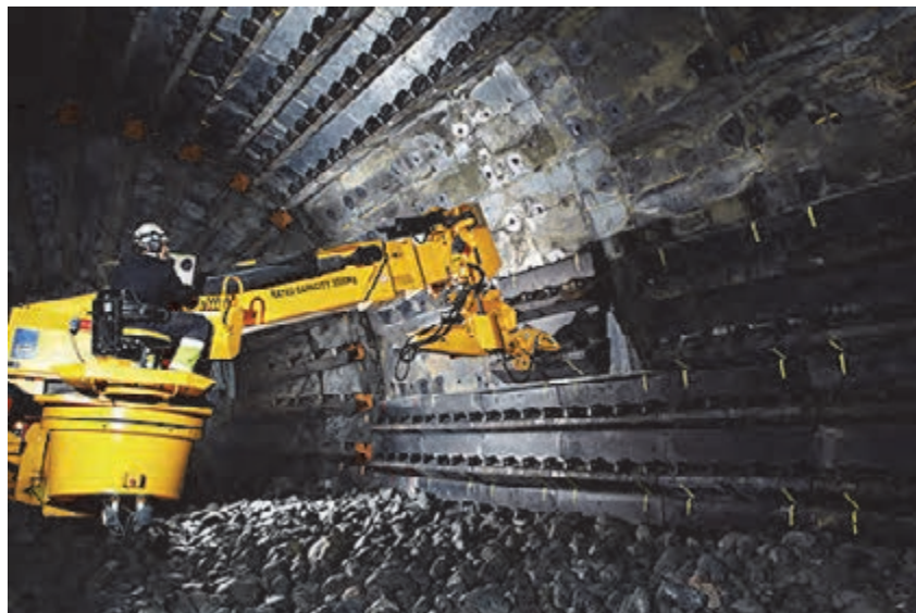
نحوه تعویض آسترهای دستگاه آسیا
