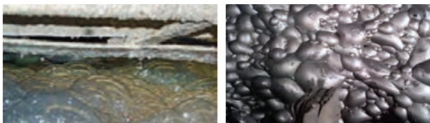
حباب‌های کروی و چند وجهی در فلوتاسیون
